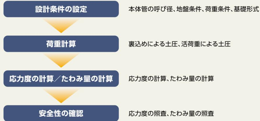
道路に埋設する高密度ポリエチレン管の管体の埋設設計は、道路土工カルバート工指針のたわみ性パイプカルバートに従い、曲げによる許容応力度と許容たわみ率の照査を行うものとします。
